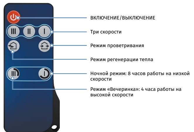
Установка **VENTO Expert DUO** может работать как независимое устройство или может быть соединена с другими установками в доме под управлением ведущего устройства. В этом случае только ведущая установка принимает сигнал от пульта дистанционного управления.
