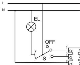
Вентилятор включается на одну из 2-х скоростей с помощью внешнего переключателя **S** (например, CDP-2/5), при этом параллельно в помещении включается освещение, или выключается параллельно с выключением освещения. Вентилятор включается/выключается только синхронно с освещением.
