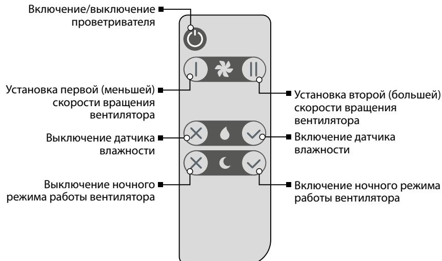
При включении с помощью кнопки **Включение/выключение** на пульте дистанционного управления проветриватель начинает работать на той скорости, при которой он был выключен.
