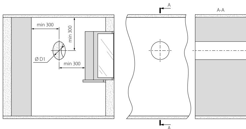
2. Установите воздуховод в отверстие таким образом, чтобы его срезы совпадали с наружной и внутренней поверхностью стены. Для удобства монтажа используйте монтажные клинья, которые входят в комплект поставки.
