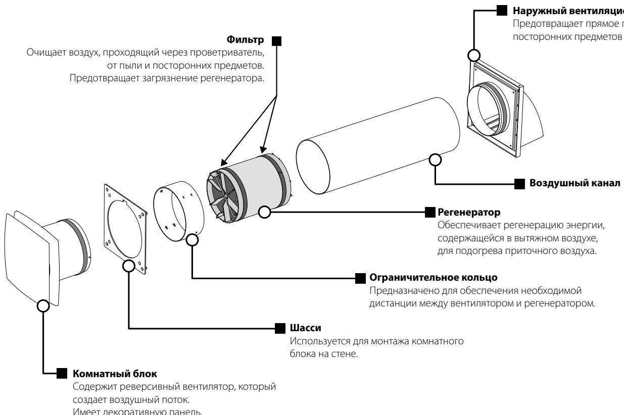
Проветриватель работает в два цикла по 60 секунд.
