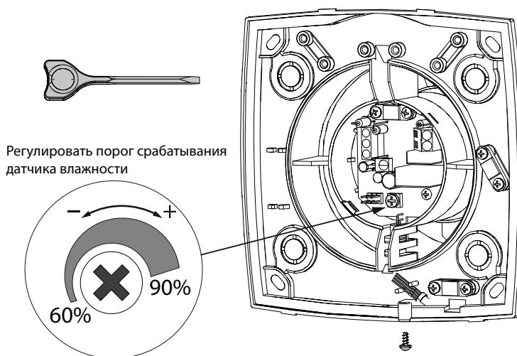
При включении ночного режима проветриватель работает на первой (меньшей) скорости в течение 8 часов. В это время снижается яркость светодиода и проветриватель не реагирует на переключение скоростей и срабатывания датчика влажности.
