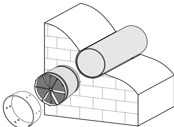
4. С помощью отвертки выкрутите саморез из корпуса и снимите фронтальную часть комнатного блока.
