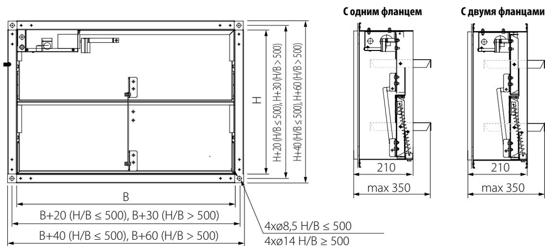
**Клапан RSKM с электроприводом (230 или 24 В), установленным снаружи клапана с одним или двумя фланцами:**
