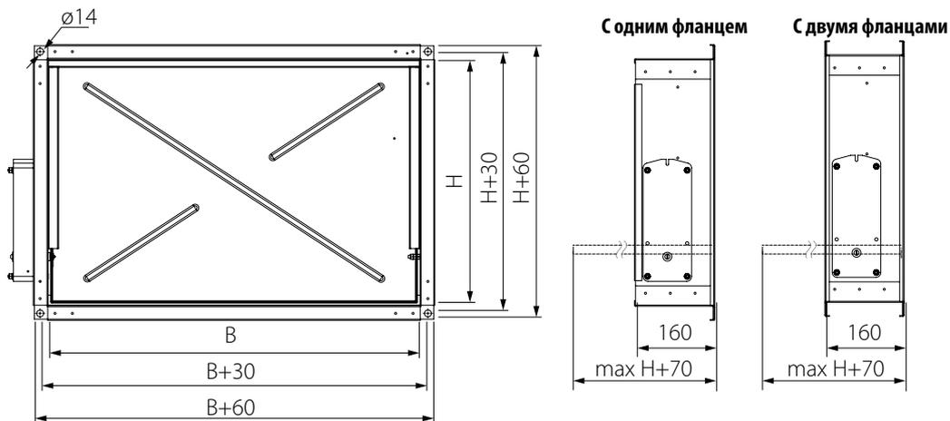
**Клапан RSKE с электроприводом (230 или 24 В), установленным внутри клапана с одним или двумя фланцами:**
