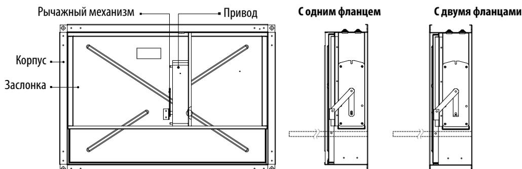
**ГАБАРИТНЫЕ И ПРИСОЕДИНИТЕЛЬНЫЕ РАЗМЕРЫ КЛАПАНОВ RSKE, мм**
