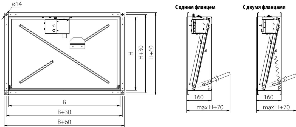
**Клапан RSKE с электроприводом (230 или 24 В), установленным снаружи клапана с одним или двумя фланцами:**
