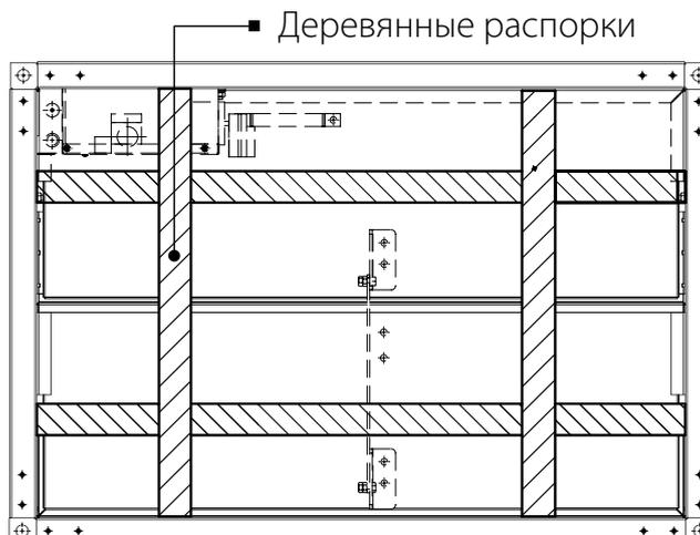
При подготовке клапана к монтажу распереть корпус клапана деревянными распорками для предотвращения возможных перекосов, скручивания или нарушений геометрии корпуса, которые могут привести к защемлению створки, и в конечном итоге к потере функциональности клапана.
