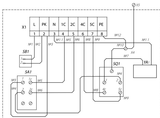
Маркировка выводов устройств и клеммных зажимов колодки X1 приведена условно.
