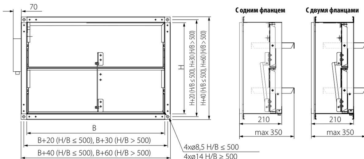
**Клапан RSKM с электроприводом (230 или 24 В), установленным внутри клапана с одним или двумя фланцами:**
