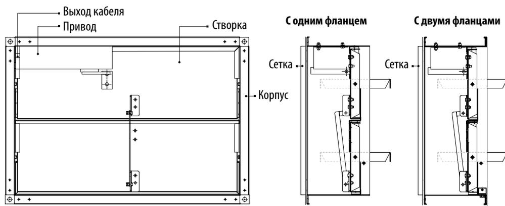
**ГАБАРИТНЫЕ И ПРИСОЕДИНИТЕЛЬНЫЕ РАЗМЕРЫ КЛАПАНОВ RSKM, мм**
