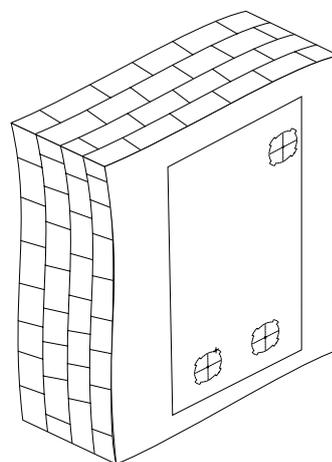
Снимите шаблон и просверлите в стене два сквозных отверстия  $\varnothing$  120 мм для круглых воздухопроводов.
