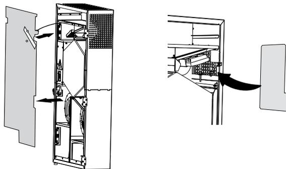
Поднимите установку, вставьте патрубки в соответствующие установленные в стене воздуховоды. Наклон воздуховодов должен быть минимум 3 мм.
