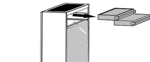
Если установлен вытяжной патрубок, снимите верхнюю защитную панель и установите магнитную заглушку на вытяжную решетку.
