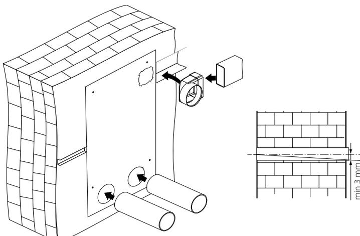
Для установки вытяжного патрубка необходимо демонтировать заглушку на тыльной стороне установки.
