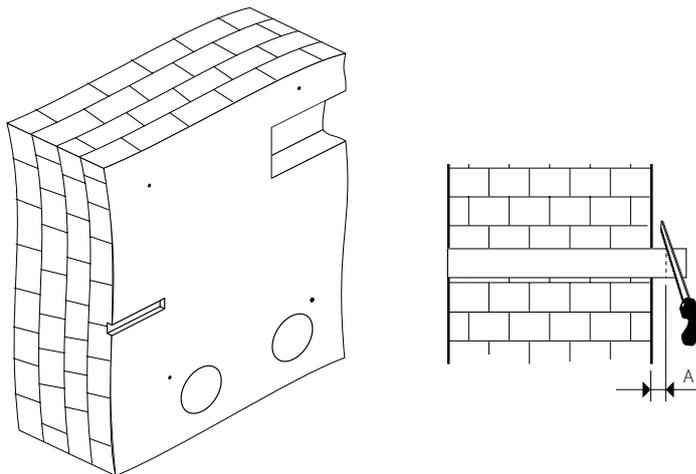
Вставьте воздухопроводы в соответствующие отверстия шаблона. Обеспечьте минимальный уклон воздуховода 3 мм в сторону улицы для отвода конденсата.
