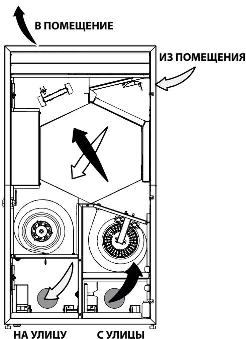
Теплый загрязненный воздух из помещения поступает в установку, где очищается с помощью вытяжного фильтра, далее воздух проходит через рекуператор и с помощью вытяжного вентилятора по воздуховоду удаляется на улицу. Чистый холодный воздух с улицы по воздуховодам поступает в установку, где очищается с помощью приточного фильтра, далее проходит через рекуператор, подогревается за счет тепла вытяжного воздуха и с помощью приточного вентилятора подается в помещение.
