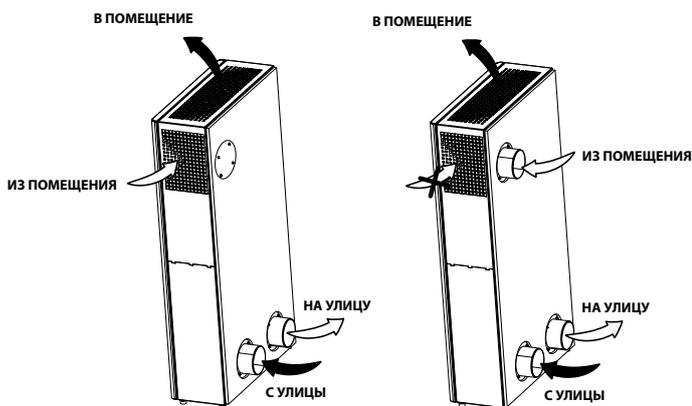
В установке предусмотрен монтаж вытяжного патрубка ( $\varnothing 100\text{ мм}$ ) для обслуживания другого помещения, например, ванной комнаты. Патрубок входит в комплект поставки. Вытяжная решетка должна быть закрыта магнитной заглушкой, входящей в комплект поставки (см. раздел "Монтаж и подготовка к работе").
