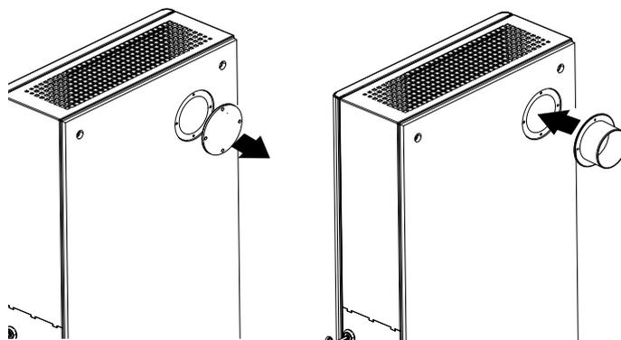
Откройте установку. Открутите винты и снимите защитную панель для доступа к монтажным отверстиям.
