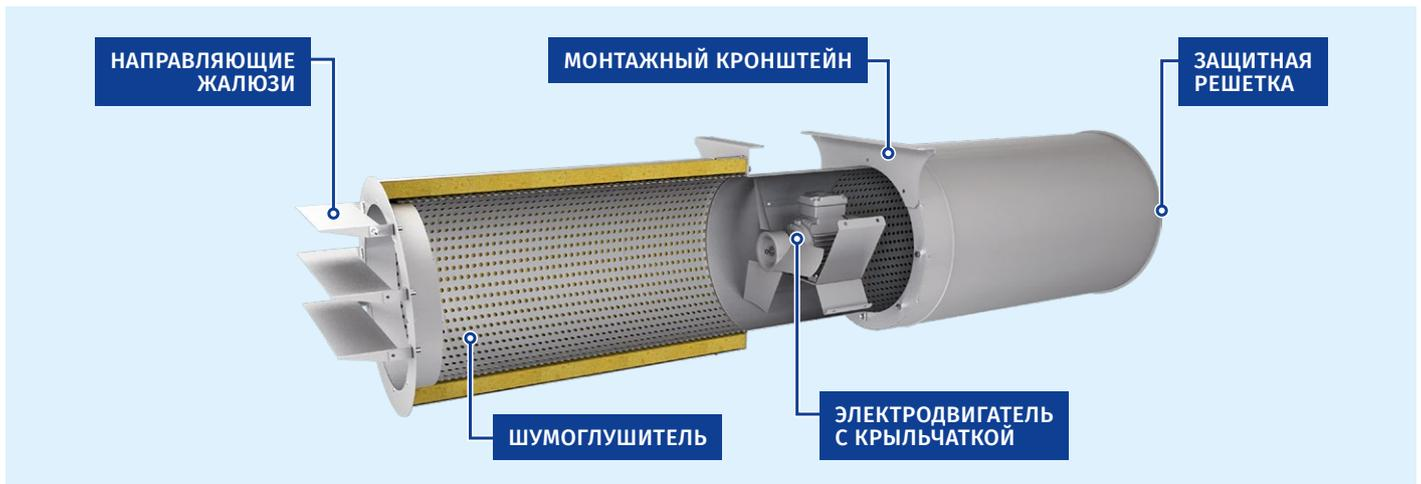
**Модель осевого струйного вентилятора Axis-Jet-VI**
