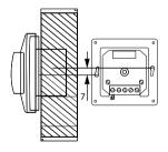
Регулятор должен устанавливаться на вертикальной стене внутри помещения в скрытой монтажной коробке.
