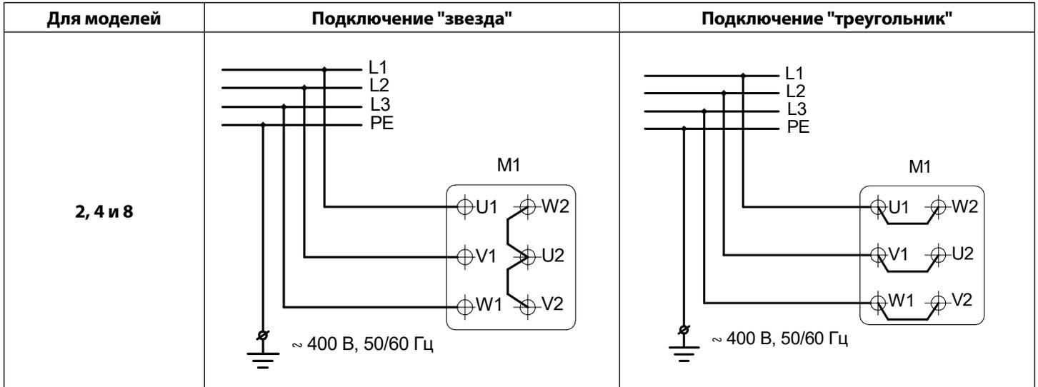
**СХЕМА ПОДКЛЮЧЕНИЯ ТРЕХФАЗНОГО ДВУХСКОРОСТНОГО ДВИГАТЕЛЯ**
