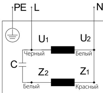
**СХЕМА ПОДКЛЮЧЕНИЯ ТРЕХФАЗНОГО ОДНОСКОРОСТНОГО ДВИГАТЕЛЯ**
