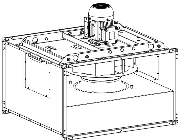
Корпус вентилятора изготовлен из оцинкованной стали. Для периодического осмотра на корпусе вентилятора предусмотрены ревизионные люки. Электродвигатель установлен вне перемещаемого воздушного потока. Рабочее колесо с загнутыми назад лопатками изготовлено из жаропрочной стали. Для регулирования частоты вращения вентилятор может быть оснащен частотным преобразователем (не входит в комплект поставки, заказывается отдельно)
