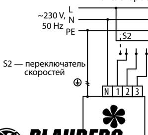
**Box** — подключение вентилятора
